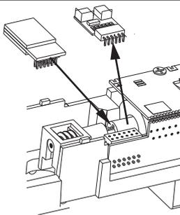
Zum Einbau eines PluX12 Decoders nach NEM 658 wird der Entstörsatz mit der Adapterleiterplatte abgezogen. Danach kann ein PluX12 Decoder eingesteckt werden.
