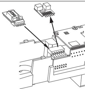
Zum Einbau eines Decoders nach NEM 651 S klein wird nur der Entstörsatz abgezogen. Danach kann ein Decoder nach NEM 651 S klein eingesteckt werden. Hierfür empfehlen wir einen Decoder von Uhlenbrock (TILLIG Artikel-Nr. 66021).
