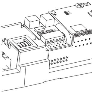
Für eine Digitalisierung gibt es im Modell eine PluX12 Schnittstelle. Wir empfehlen die Verwendung eines Decoders PluX12 von Uhlenbrock (TILLIG Art.-Nr. 66024). Zum Einbau des Decoders ist das Oberteil entsprechend der Anleitung (Seite 1) abzunehmen. Seitlich in der Rahmenaussparung befindet sich die Decoderschnittstelle.
