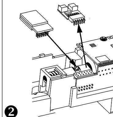
**2** (DE) Zum Einbau eines PluX12-Decoders nach NEM 658 wird der Entstörersatz mit dem Adapterleiterplatte abgezogen. Danach kann ein PluX12-Decoder eingesteckt werden.
