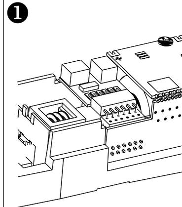
**1** (DE) Für eine Digitalisierung gibt es im Modell eine PluX12-Schnittstelle. Wir empfehlen die Verwendung eines Decoders PluX12 von Uhlenbrock (TILLIG Art.-Nr. 66035). Zum Einbau des Decoders ist das Oberteil entsprechend der Anleitung auf Seite 1 abzunehmen. Seitlich in der Rahmenaussparung befindet sich die Decoderschnittstelle.
