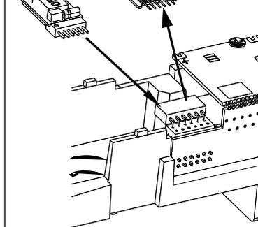
**3** (DE) Zum Einbau eines Decoders nach NEM 651 S klein wird nur der Entstörersatz abgezogen. Danach kann ein Decoder nach NEM 651 S klein eingesteckt werden. Hierfür empfehlen wir den Decoder von Uhlenbrock (TILLIG Art.-Nr. 66032).
